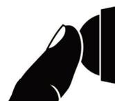
**REMARQUE :** Si l'on appuie trop souvent sur l'amorce, une quantité excessive de carburant pénètre dans le carburateur, ce qui entraîne des difficultés de démarrage.
